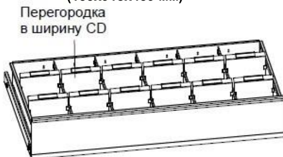
5xКД-516/536 Перегородка в глубину +12xКД-516/536 Перегородка в ширину CD (шесть ячеек с шириной 153 мм)
